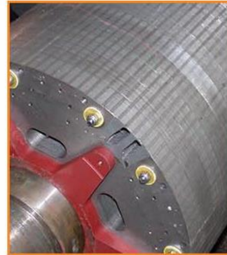
MAGNETI PERMANENTI ANNEGATI INTERAMENTE NELLA STRUTTURA DEL ROTORE
